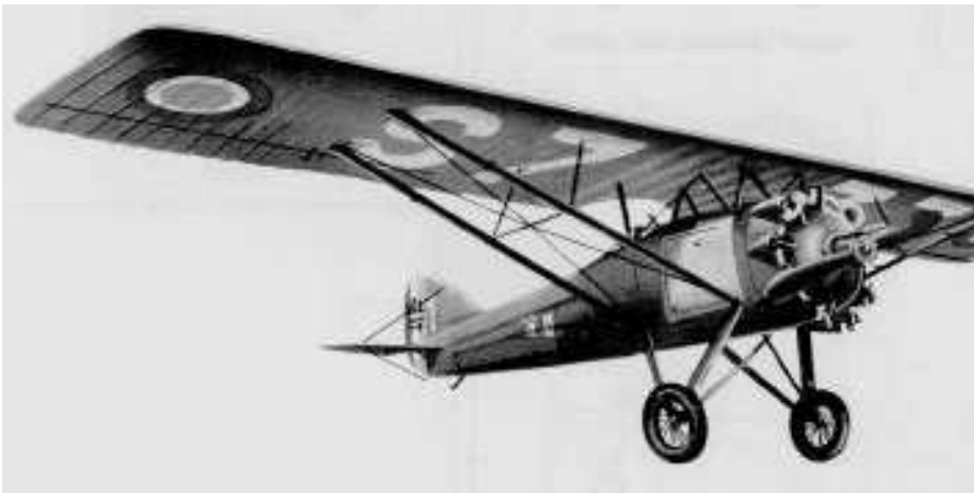
Un GL-32 de una serie que ya tiene patas independientes en el tren de aterrizaje.
